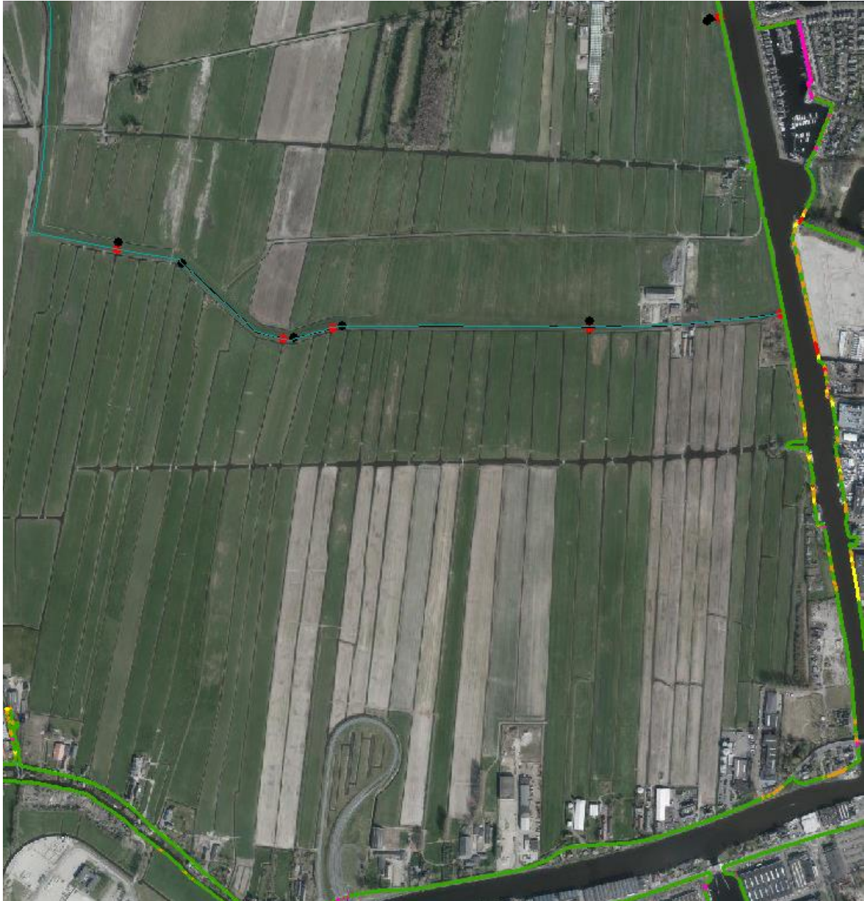
Figuur 3.13: Hoogtetoets 2024 (concept); oranje strekkingen hebben hoogtetekort tot 10 cm
